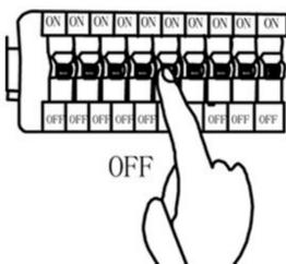
Isključiti mrežni napon na već montiranoj šini.
